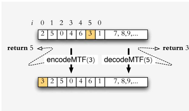
Pour transmettre le prochain entier  $n$ , on identifie son unique position  $i$  dans la permutation ( $\pi[i] = n$ ), et on émet  $i$ . En même temps, on performe une rotation circulaire de  $\pi[0..i]$  qui place  $n$  en position 0. Dans la permutation résultante  $\pi'$ , on a  $\pi'[0] = \pi[i]$ ,  $\pi'[j] = \pi[j - 1]$  pour  $j = 1, 2, \dots, i$  et  $\pi'[j] = \pi[j]$  pour tout  $j > i$ .
