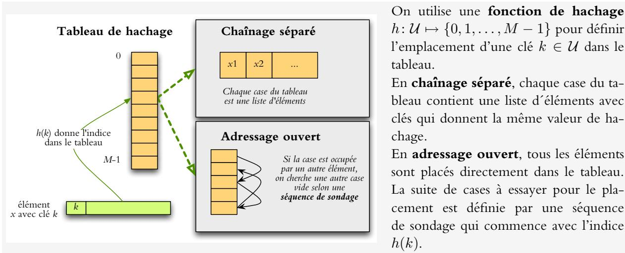
Un tableau de hachage performe bien dans **le cas moyen** — dans le pire cas, la performance est comme pour une liste chaînée ( $\Theta(n)$  pour insérer ou rechercher). Idéalement, on veut utiliser une fonction de hachage qui mène à une **distribution uniforme** de  $h(k)$ . La performance moyenne est déterminée par la **facteur de charge**  $\alpha = n/M$  quand on a  $n$  éléments dans le tableau.
