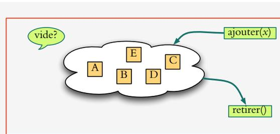
Une **file** généralisée est un type abstrait pour une collection d'éléments avec deux opérations principales : une opération pour ajouter un élément, et une autre pour retirer un élément. (En général, il y a d'autres opérations auxiliaires comme tester si la file est vide.) La règle du choix de l'élément à retirer fait partie de la définition de l'interface : queue (first-in-first-out), pile (last-in-first-out), file de priorité (élément de priorité maximale).
