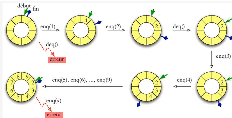
Idée : circulariser le tableau par deux indices pour le début et fin de la queue : on utilise  $(\text{mod } n)$  avec taille  $n$ .
