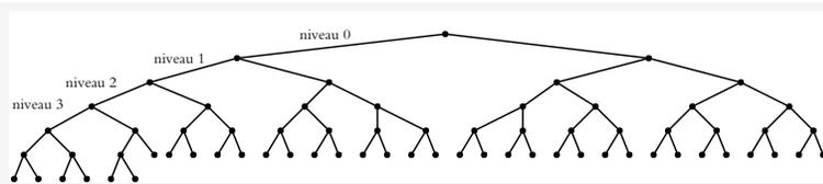
Un **arbre binaire complet** de hauteur  $h$  : il y a  $2^i$  nœuds à chaque niveau  $i = 0, \dots, h - 1$ . On «remplit» les niveaux de gauche à droit.
