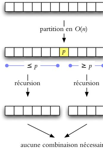
En **tri rapide**, on choisit un **pivot**  $p$ , et à l'aide des échanges d'éléments, on place les éléments inférieurs à  $p$  à la gauche, et ceux supérieurs à  $p$  à la droite du tableau. Après une telle partition, on peut procéder avec des appels récursifs aux deux sous-tableaux gauche et droit. Notez que le pivot n'est pas nécessairement la médiane : les sous-tableaux gaches et droits résultants peuvent avoir des tailles très différentes. La partition même suit la logique du tri binaire.
