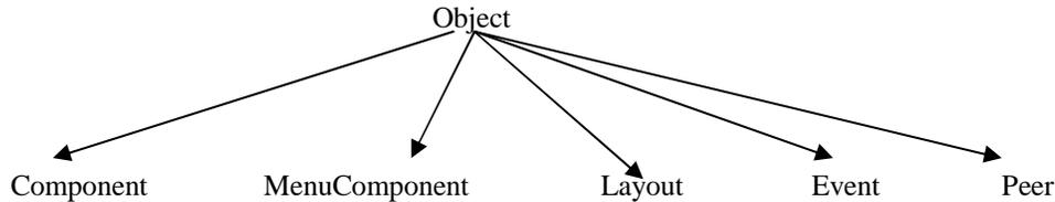
Layout : Dans une toolkit graphique, les placements des objets graphiques sont calculés et non précisés par des coordonnées absolues. Les layout précisent les contraintes de placement des objets graphiques contenu dans un container.
