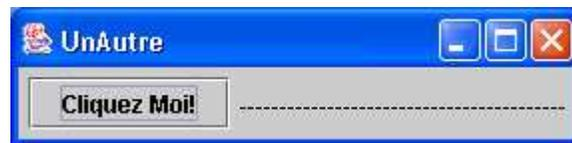
*On crée une fenêtre dans laquelle se trouve un Panel qui contient un bouton et un label. Le bouton contient l'étiquette "Cliquez Moi!" et le label une série de -. On a associé aussi à la fenêtre deux types d'événements. Un sur le bouton "Cliquez Moi!", un autre sur le l'onglet de fermeture de la fenêtre.*
