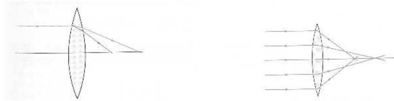
FIG. 2.4 – Deux exemples d’aberrations : à gauche, des rayons lumineux de couleurs différentes sont focalisés à des points différents dans un exemple d’aberration chromatique ; à droite, l’aberration sphérique pousse les rayons à être redirigés vers des points différents selon leur point d’intersection avec la lentille (source : [4]).
