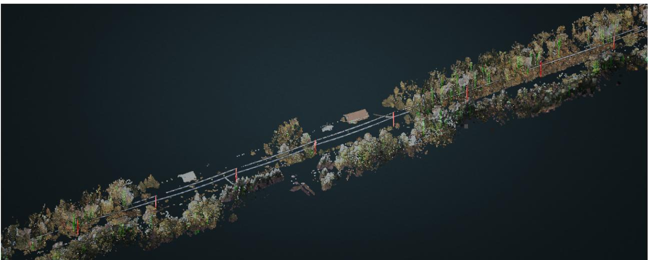
Figure 10: Exemple de résultat de détection de cylindres avec RANSAC et visualisation avec Potree. Les cylindres détectées sont colorés en rouge pour les poteaux électriques et en vert pour les troncs d'arbres. La distinction entre les deux groupes a été réalisée manuellement.
