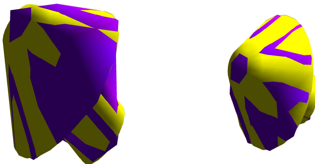
FIG. 4.9 – Diagramme de répartition d'erreurs. Superposition de l'image de référence et de l'image obtenue selon deux points de vue.
