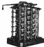
Cette machine utilise le système décimal: la manivelle fait tourner les roues par dixièmes de tour. En raison de sa complexité (25 000 pièces) et de son coût, aucune des deux versions de cette machine ne sera complètement finie par BABBAGE bien que le principe du calculateur soit parfaitement exact comme l'ont prouvé des chercheurs Britanniques qui en ont réalisé un exemplaire en 1991.
