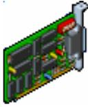
**Carte d'interface réseau (NIC, Network interface card) :** adaptateur qui permet à une station de travail de se connecter au réseau et de communiquer avec d'autres ordinateurs. Il existe une gamme de spécifications adaptées aux besoins de la station de travail et du réseau (débit de transmission 10 Mb/s ou 100 Mb/s, Ethernet ou Token Ring ). Elles sont aussi appelées cartes réseau et adaptateurs réseau.
