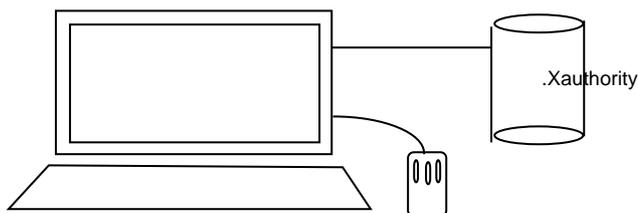
Lorsque l'utilisateur U tout en restant dans la même session X Window se connecte sur une machine distante M2 et demande à exécuter un programme graphique P sur la machine M2 avec affichage sur la machine M1, ce programme va lire le fichier .Xauthority de l'utilisateur U sur la machine M2.
