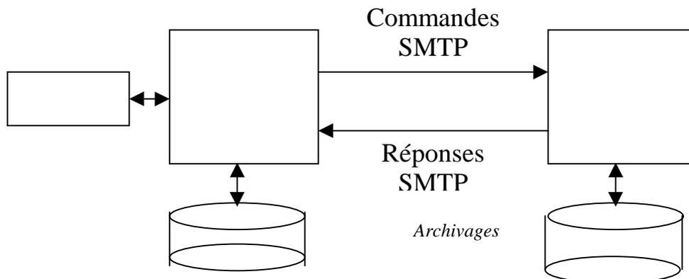
Le diagramme en flèches d'échange de messages suivant présente un cas de transmission d'un courrier d'un client vers un serveur de messagerie.
